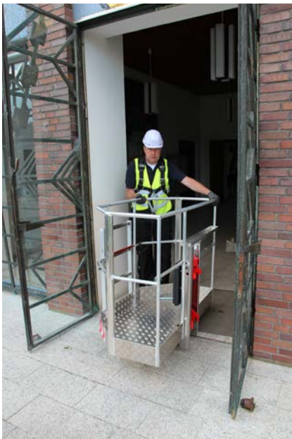
Minimale Durchfahrbreite von 0,78 m durch abnehmbaren Arbeitskorb
