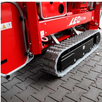
Verstellbares Kettenfahrwerk zum Ausgleich von Geländeneigungen
